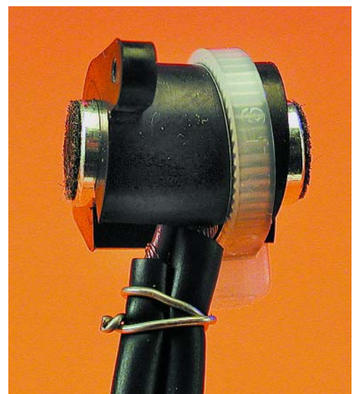
Bild 3. Die entsprechend Bild 2 zusammengebauten Mikrofonkapseln.
